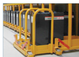
Wymiana baterii poprzez łoża rolkowe
