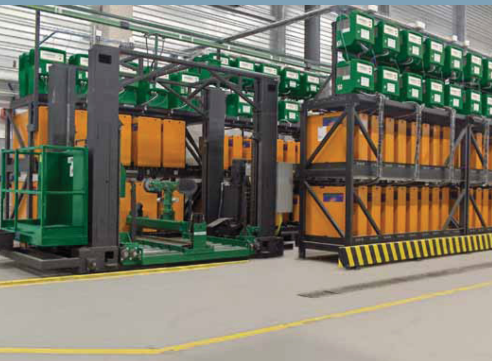
Batteriewechselstation mit der vollautomatisch angetriebenen Batteriewechselanlage trak® Xchange FU
